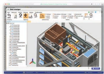
Mit dem 3D-CAD-Viewer können 3D-Modelle direkt im Browser auf dem PC oder auf einem mobilen Gerät betrachtet werden.
